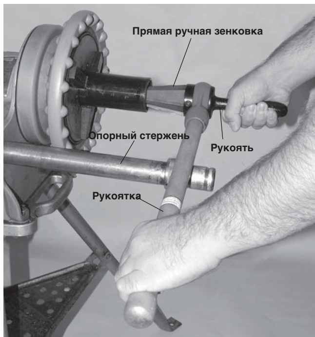
Рисунок 6 – Обработка трубы ручной зенковкой
