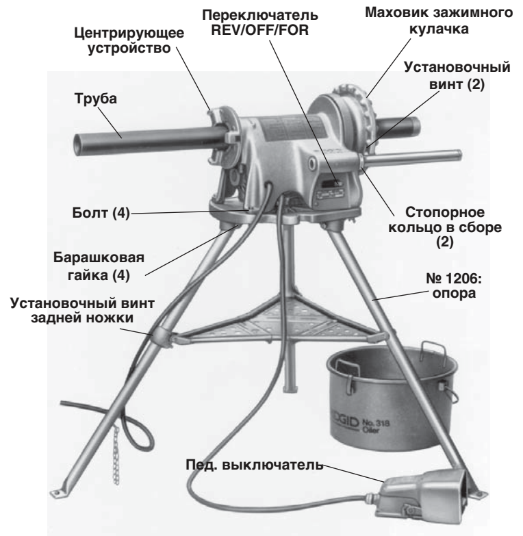
Рисунок 3 – Силовой привод № 300, установленный на опору № 1206 со смазчиком № 418
