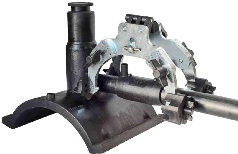
Компактный универсальный позиционер KELA предназначен для фиксации и центровки полимерных труб  $\varnothing$  16-63мм во время сварки с помощью фитингов с закладными нагревателями (муфт и отводов 45° и 90°).
